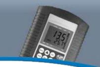
Il nuovo ossimetro portatile AL 20 Oxi, controllato da microprocessore, è lo strumento robusto e affidabile per la misura quotidiana.
